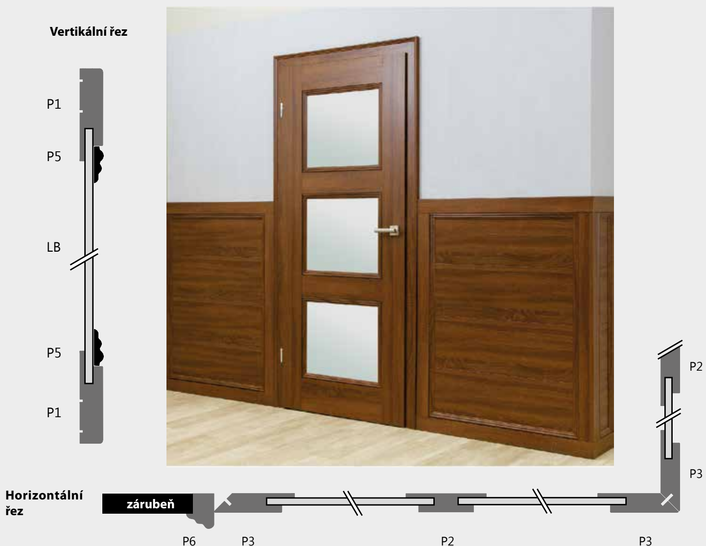
Schéma provedení rohového obkladu stěny
